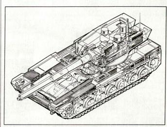
Projekt eines amerikanischen Zukunftpanzers (ca. 48t), ausgerüstet mit elektronischen Sensoren, aktivem Schutzsystem und «stealth-jacket».
