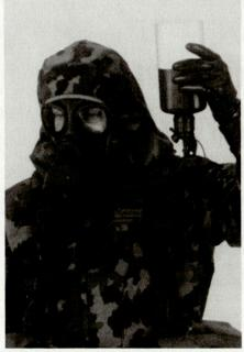
ABC-Schutzmaske 90 mit Trinkvorrichtung (Fotos: Stab GGST, Abt. ACSD)
