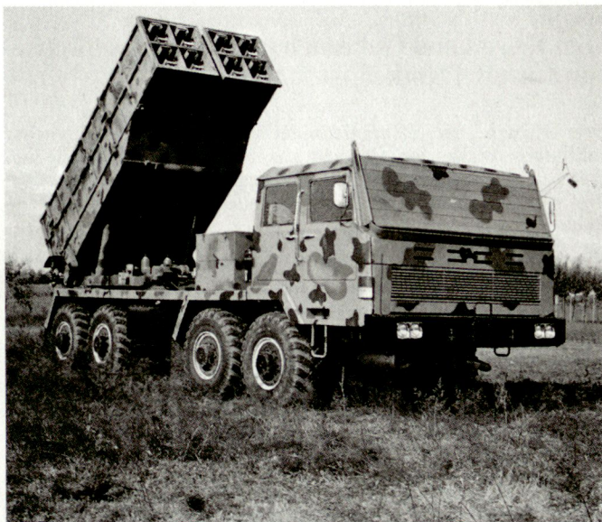
Schwerer Mehrfachraketenwerfer WM-80 vom Kaliber 273 mm, der heute von China zum Verkauf angeboten wird.
