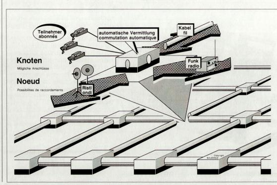
Die IMFS-Kunden können sich an den Knoten im Gitternetz mit unterschiedlichsten Mitteln «anhängen». Die Illustration verdeutlicht auch die übertragungsseitige Redundanz dieses Systems bei Ausfällen. (Grafik: BAUEMsid) Übertragungsstrecken, vorwiegend Richtstrahl, sind zum Gitter vermascht, wodurch der Einfluss von Teilausfällen reduziert wird. Je nach verwendeten Endgeräten «transportiert» das IMFS Sprache, Daten und Bilder innerhalb eines Korps und über Anschlussstellen zu andern Adressaten.
