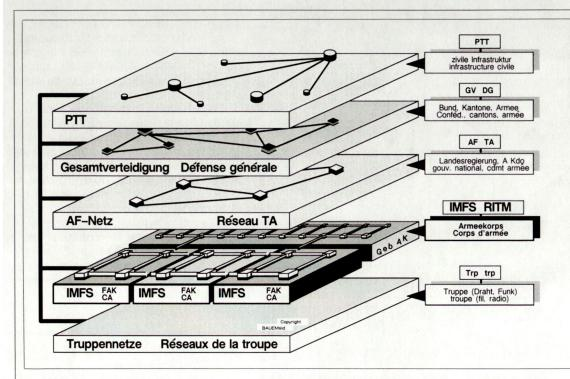
Die Ebenenstruktur der integrierten Übermittlung. Das Schwergewicht der Verbindungsleistungen zugunsten der Truppe wird in der IMFS-Ebene liegen. (Grafik: BAUEMsid)
