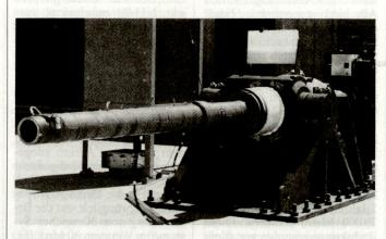
Elektromagnetische Kanone im Versuchsstadium. Vorgesehen ist der Einbau solcher Hochleistungskanonen auch in zukünftigen Kampfpanzern.
