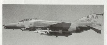
Ein F-4G Wild Weasel der US Air Force mit Lenkwaffen HARM und Maverick, Geräten für die Zielsuche sowie für elektronische Gegenmassnahmen. Der Zusatzbehälter unter der Rumpfnase enthält den APR-47 (Radar Homing and Warning).
