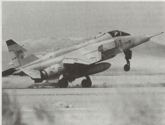
Mehrzweck-Kampfflugzeug Jaguar, ausgerüstet mit Luft-Boden-Lenkstoff AS-30.
