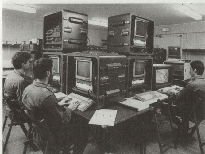
Komponenten des automatisierten Führungssystems RITA. Menschen und Maschinen synthetisieren eine grosse Informationsmasse auf einem KP, um Entscheidungshilfen zu bieten.
