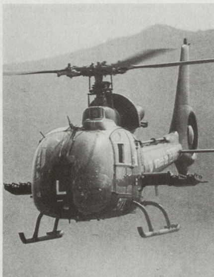
Helikopter Gazelle (Version Celtic) waren im Golfkrieg erstmals auch mit Luft-Luft-Lenkstoff Mistral ausgerüstet.
