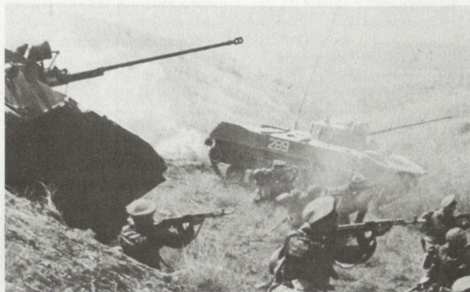
Die sowjetischen Luftlandedivisionen sind heute grösstenteils mit mechanisierten Kampfmitteln ausgerüstet, im Bild Luftlandeschützenpanzer BMD-2 mit 30-mm-Automatenkanone.
