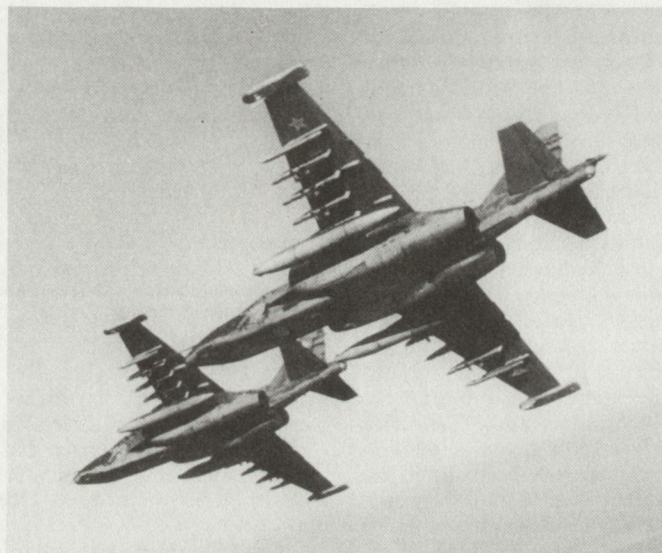
Erdkampfflugzeuge Su-25 Frogfood. Gut sichtbar sind die Unterflügelstationen für eine Waffenzuladung von max. 4400 kg.
