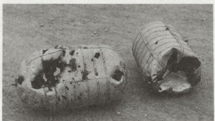
Abb. 2: Fliegende Festung «Alvaneu», Flab-Splitter in Sauerstofftank (Atmung).
