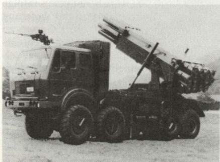
Schwerer Mehrfachraketenwerfer 262 mm aus jugoslawischer Produktion, die maximale Schussdistanz liegt bei 60 km.
