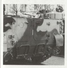
Heckansicht des schwimmfähigen BMP-3 mit den beiden Hecktüren und den Öffnungen für die Wasserstrahlantriebe
