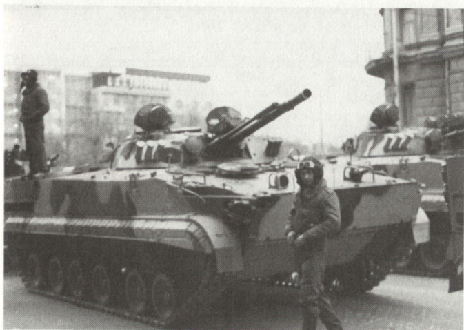
Hauptbewaffnung des neuen BMP: Kanone, vermutlich vom Kaliber 100 mm und parallel dazu eine 30-mm-Automatenkanone
