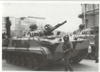
Hauptbewaffnung des neuen BMP: Kanone, vermutlich vom Kaliber 100 mm und parallel dazu eine 30-mm-Automatenkanone
