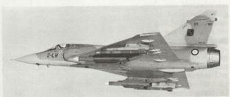
Mirage 2000-Abfangjäger der «Armée de l'Air». Unter dem Flügel sind zwei IR-gelenkte Matra 550 Magic-Lenkwaffen für den Luftnahkampf sowie zwei radargesteuerte Matra Super 530-Lenkwaffen für den Luftfernkampf ersichtlich.
