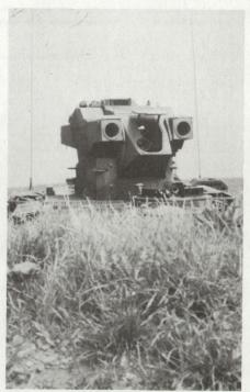
Bild 2. Panzerjäger in der Feuerstellung, exponierte Fläche 1,6 m<sup>2</sup>
