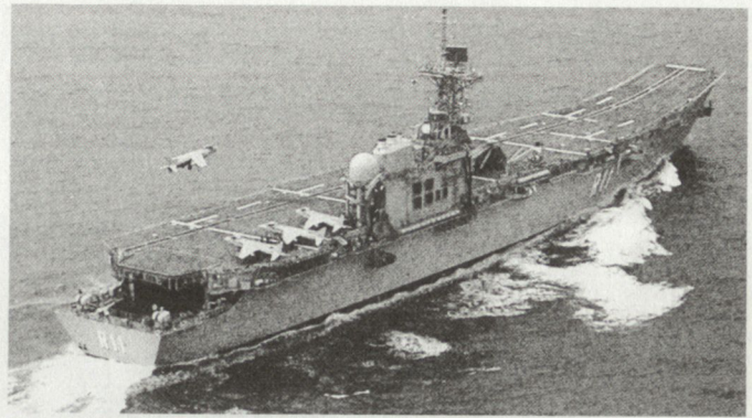
Der V/STOL-Flugzeugträger «Principe de Asturias» (Länge 196 m, Breite 24,4 m, Pistenbreite 29 m, 800 Mann Besatzung). Ein Harrier AV-8B ist auf dem Landeanflug.
