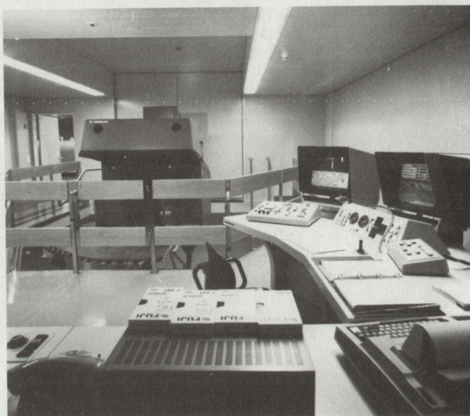
Abb. 5: Fahr Simulator «FASIP Leo», Fahrer kabine und Ausbilder-pult
