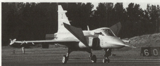
Der JAS-39 Gripen ist ein Kampfflugzeug der nächsten Generation. Durch blosses Anstellen der Vorflügel wird die Auslaufstrecke auf weniger als 500 m reduziert.
