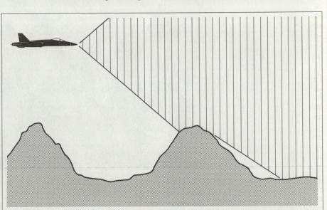
Abb. 1: Luftlageerfassung mit Bordradar
