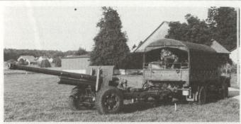
Abb. 2: Ohne Protze direkt am Zugfahrzeug angehängtes Geschütz bezieht Stellung.
