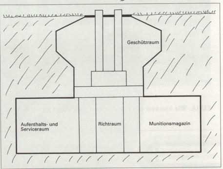
Abb. 1: Prinzipschema eines Fest Mw 59/83
