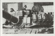
Abb. 3: Kampfpanzer T-72 M2 mit dreifacher Reaktivpanzerung
