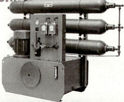
...als Beispiel für kontrollierte Bewegung + beherrschte Kraft: Spezial-Hydraulikanlage mit Speichern für das Schwebebahn-Transitsystem in Memphis.
