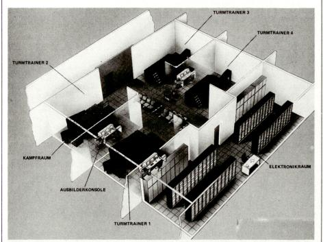
Abb. 1. Elektronische Schiessanlage für Panzer 87 Leopard (ELSALEO), Gesamtübersicht.
