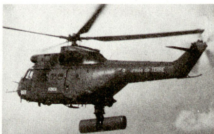
Helikopter Super Puma mit ausgefahrener Antenne des Gefechtsfeldüberwachungssystems «Orchidée».
