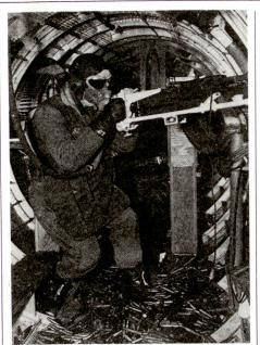
Abb. 2 MG-Schütze mit Brustfallschirm, Sauerstoff-Maske (kollektive Versorgung für die ganze Besatzung) und Sonnenbrille für den Einsatz gegen Angriffe aus der Sonne. Ausstieg durch MG-Scharte möglich.
