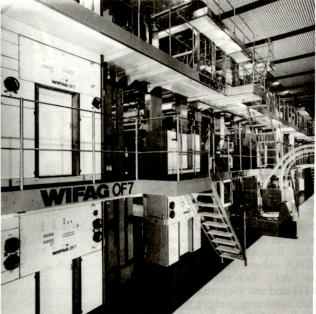
Hochleistung-Rollenoffsetmaschine WIFAG OF7.
