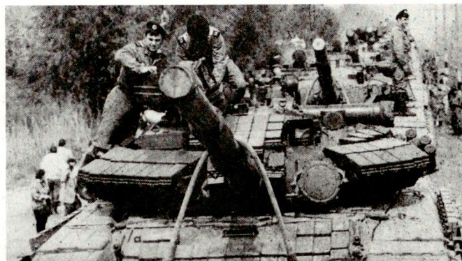
Abzug sowjetischer Panzer aus Ungarn. Zu beachten ist die angebrachte Reaktivpanzerung z. T. auch seitlich über den Schürzen
