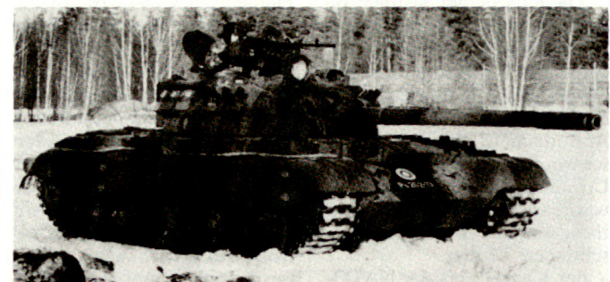
Abb. 2: Modernisierter Kampfpanzer T-55M, ausgerüstet mit Seitenschürzen, Nebelwerfern und neuer Feuerleitanlage.
