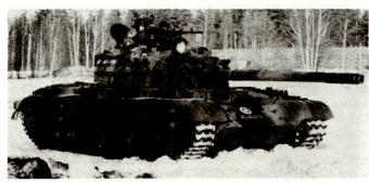
Abb. 2: Modernisierter Kampfpanzer T-55M, ausgerüstet mit Seitenschürzen, Nebelwerfern und neuer Feuerleitanlage.
