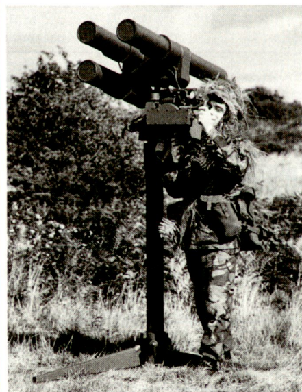
L Flab-Lenkwanne Starstreak. Einsatz ab Schulter, als leichter Dreifachwerfer oder als Achtfachwerfer ab Schützenpanzer.
