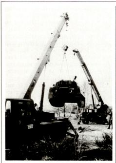
Abb. 5. Bergen einer defekten Panzerhaubitze 122 mm
