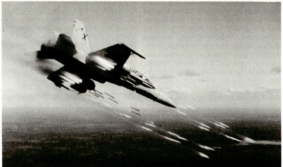
Abb. 7: Eine CF-18 der kanadischen Luftstreitkräfte beim Abschuss von un gelenkten 70-mm-Raketen des Typs CRV7. Ungelenkte Raketen modernster Bauart stellen eine kostengünstige Waffe für die Bekämpfung von gepanzerten Kampffahrzeugen dar, zwingen das Flächenflugzeug jedoch zum Fliegen eines stark flugabwehrgefährdeten Angriffsprofils. Beim Einsatz ab Panzerabwehr- und Kampfhubschraubern dienen sie der Bekämpfung von leicht- und ungepanzerten Flächenzielen, wie Kolonnen von Schützenpanzern oder Nachschubfahrzeugen.
