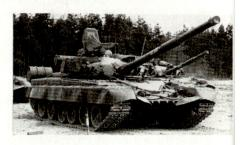
Bei der Version ohne Reaktivpanzerung ist ersichtlich, dass das für T-64 und T-72 charakteristische Abweiserdreieck fehlt. Verschieden ist auch die Anbringung der Nebelwerfer, drei an der rechten und fünf an der linken Turmseite. Über den Nebelwerfern an der rechten Seite ist auch der ominöse Kasten zu erkennen, der die Lenkantenne für die durch das Rohr verschossene PAL AT-8 SONGSTER beinhaltet.
