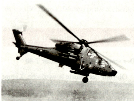
Seit letztem Oktober steht der PAH A-129 MANGUSTA im Dienst. Er verfügt über eine Bewaffnung von 8 PAL TOW-2 und eine Abschussvorrichtung für un gelenkte Raketen. Diese Panzerabwehrhelikopter sollen im Einsatz von Beobachtungshelikoptern des Typs A-109 begleitet werden. (Aus 8/88)
