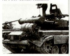
Bei der Heckansicht fällt der markante Auspuffteil der neu verwendeten Gasturbine auf. Der Durchmesser des mitgeführten Schnorchels ist etwas grösser als bei T-64 und T-72. Da die Turbine bei der Unterwasserfahrt auch mit Verbrennungsluft versorgt werden muss, wird ein spezieller Verteilkasten (am Turm rechts, unter der Flab Mg angebracht) benötigt.
