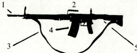
Die Verwendung von Isolierband ist geeignet. Jedoch Vorsicht, dass Hülsenauswurfsystem und Ladeanzeiger nicht blockiert werden.
