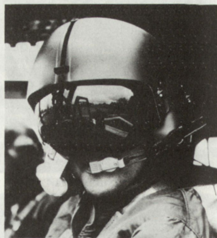
Abb. 8. Für Flugführung und Waffeneinsatz stehen der Besatzung moderner Kampfhubschrauber Helmvisier- und -blickfeldarstellungsgeschichten zur Verfügung. Mit dem auf unserem Foto gezeigten IHADSS-System, von Honeywell für den Einsatz mit dem Kampfhubschrauber AH-64A Apache entwickelt, lassen sich auch alle mitgeführten Waffen einsetzen, wobei folgende Höchstschussweiten erreicht werden: Geschützbewaffnung: 2000 m, Ungelenkte Raketen: 1500 m; Drahtgesteuerte Panzerabwehrlenkflugkörper mit Laser- oder Infrarot-Wärmebild-Zielsuchkopf: 6000–8000 m und Luftzielraketen als Bestandteil der Selbstschutzbewaffnung: 4000 m.
