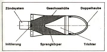
Abbildung 2: Prinzipskizze Hohlladungs-Gefechtskopf
