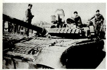
Abb. 4: Sowjetischer Kampfpanzer T-80 mit Reaktivpanzerung
