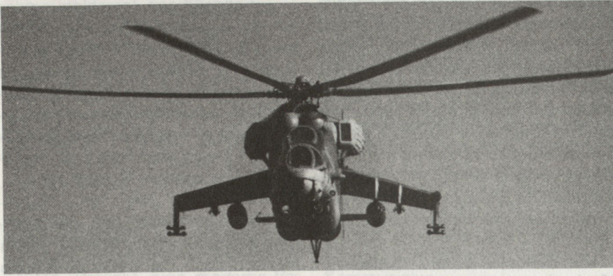
Sowjetischer Kampfhelikopter Mi-24 HIND. Deutlich sichtbar sind die seitlich montierten Abgaskühler, die dem Schutz vor Stinger-Abschüssen dienen sollen. Foto: Beat Krättli
