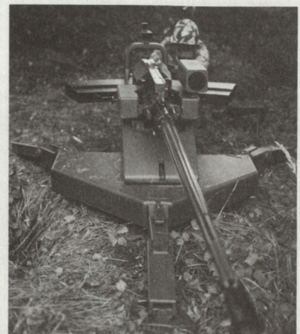
MK-25 mm (Neuentwicklung von Oerlikon Bührle; Werkaufnahme), konzipiert als Waffe zur Bekämpfung von leicht gepanzerten Fahrzeugen (zum Beispiel Schützenpanzern) und von Kampfhelikoptern.
