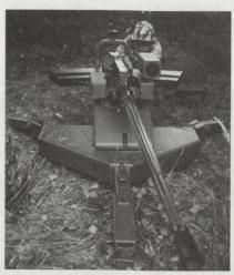
MK-25 mm (Neuentwicklung von Oerlikon Bührle; Werkaufnahme), konzipiert als Waffe zur Bekämpfung von leicht gepanzerten Fahrzeugen (zum Beispiel Schützenpanzern) und von Kampfhelikoptern.
