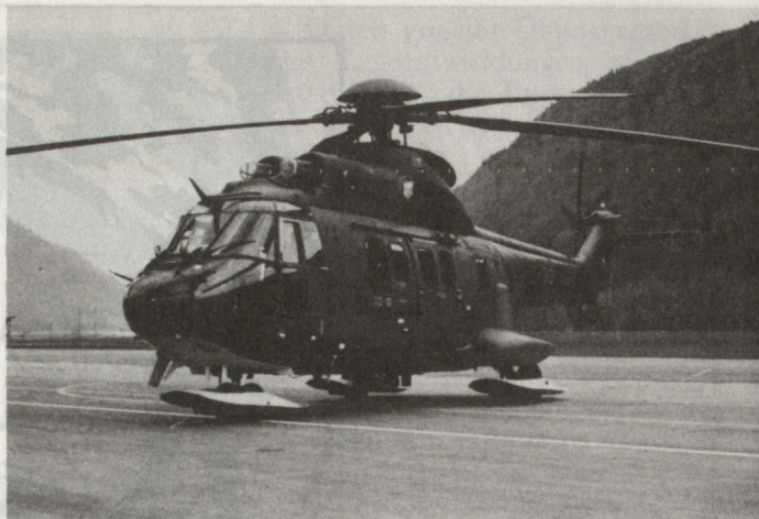
SUPER PUMA. 15 bis 18 vollausrüstete Wehrmänner oder 2000 kg Gewicht auf 2000 m Höhe. Neue Transportdimensionen im Gebirgskampf.
