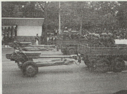
Bild 6: Kanonenhautitze D-30, 122 mm. Max. Schussweite 15,3 km.
