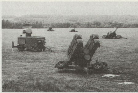
Bild 1: Feuereinheit SKYGUARD mit zwei Feldfliegerabwehrkanonen Oerlikon 35 mm und zwei Werfern für Flugkörper SPARROW. (Bild: Felix Müller)
