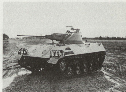
Bild 4: Schützenpanzer SAURER mit 20-mm-Schnellfeuerkanone. (Bild: Österr. Vert.-Min.)
