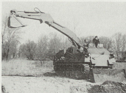
Bild 3: Pionierpanzer 4 KH 7 FA-Pi. Er ist für eine Vielzahl von Erdbewegungs- und Unterstützungsarbeiten einsetzbar. (Bild: Österr. Vert.-Min.)
