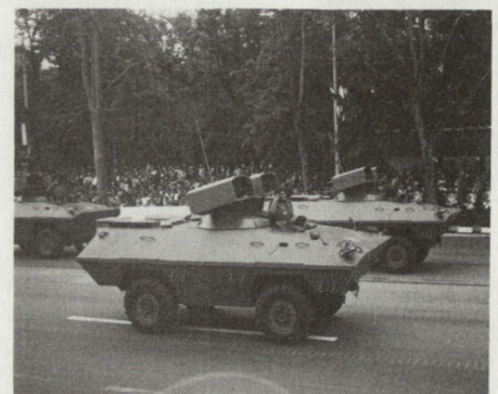
Bild 3: Raketen-Jagdpanzer BOV – 1 mit 2 x 3 PAL AT – 3 SAGGER. Reichweite 500 – 3000 m, Durchschlag 400 mm.
