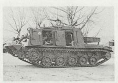
Bild 2: Bergepanzer GREIF. (Bild: Österr. Vert.-Min.)
