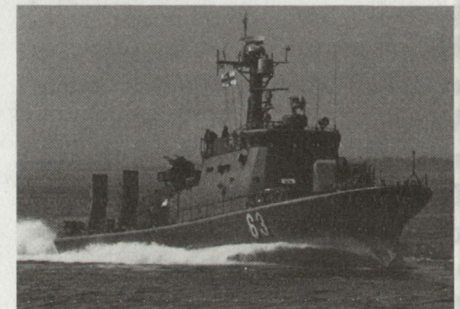
Kampfschiff der Helsinki-Klasse mit RBS-15-Lenk Waffen schwedischer Herkunft bestückt; Wirkungsabstand bis 70 km. (Photographic Center General Headquarters, Helsinki)
