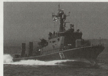
Kampfschiff der Helsinki-Klasse mit RBS-15-Lenk Waffen schwedischer Herkunft bestückt; Wirkungsdistanz bis 70 km. (Photographic Center General Headquarters, Helsinki)
