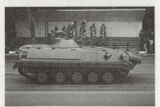
Bild 8: Kampfschützenpanzer M-80-A. Eigenentwicklung. 20 mm Sf Kan, 2 PAL AT-3, 1 Mg 7,62 mm.
