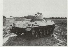
Bild 4: Schützenpanzer SAURER mit 20mm-Schnellfeuerkanone. (Bild: Österr. Vert.-Min.)
