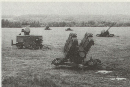
Bild 1: Feueereinheit SKYGUARD mit zwei Feldfliegerabwehrkanonen Oerlikon 35 mm und zwei Werfern für Flugkörper SPARROW. (Bild: Felix Müller)
