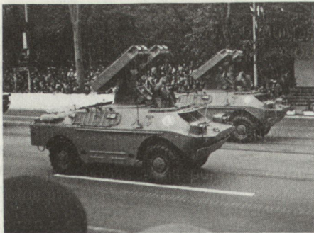
Bild 4: Flab Lenkwaffensystem SA – 9 GASKIN auf BOV. Reichweite 20 bis 6000 m.
