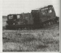
Bild 3: Bv 206 Allround-Raupenfahrzeug mit Knicklenkung und Vierkettenantrieb. (Bild: F. Müller)
