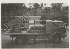
Bild 7: Mehrfach-Raketenwerfer 128 mm M-78 OGANJ, 32 Rohre mit Nachladevorrichtung.
