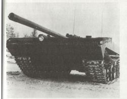
Bild 5: KPz STRV 103 C «S», 39 t, 105mm-Pz-Kanone und 2 Mg. Wegen fehlenden Turmes muss mit dem ganzen Fahrzeug grobgerichtet werden. Schwimmfähig mit Hilfsvorrichtung. Besatzung 3 Mann. (Bild Rolls Royce)
