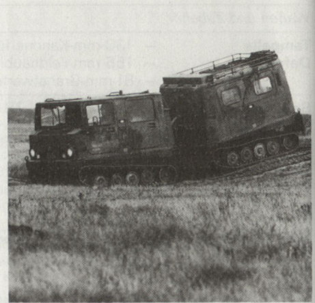
Bild 3: Bv 206 Allround-Raupenfahrzeug mit Knicklenkung und Vierkettenantrieb. (Bild: F. Müller)
