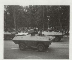
Bild 3: Raketen-Jagdpanzer BOV – 1 mit 2 × 3 PAL AT – 3 SAGGER. Reichweite 500 – 3000 m, Durchschlag 400 mm.
