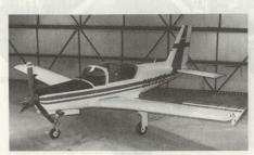
Bild 1: REDIGO L-90 Turbotrainer der Valmet Aircraft Division. Das Flugzeug ist voll kunstflugtauglich und auch für anspruchsvollere Ausbildungsstufen verwendbar. (Bild: Valmet Aircraft Division Halli)
