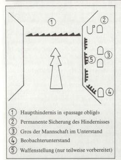
Abb. 1: Schema einer Sperrstellung
