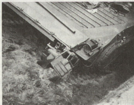
Frontansicht des neuen Minenräumgeräts, Aussenteil der Messersektion noch eingeklappt.
