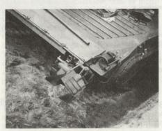
Frontansicht des neuen Minenräumgeräts, Aussenteil der Messersektion noch eingeklappt.
