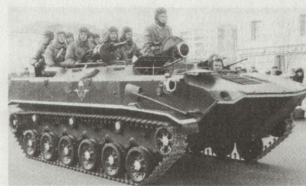
Die Transportversion des BMD-Luftlandepanzers kann neben der Besatzung noch 8 bis 10 Fallschirmjäger transportieren.
