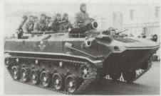
Die Transportversion des BMD-Luftlandepanzers kann nebst der Besatzung noch 8 bis 10 Fallschirmjäger transportieren.
