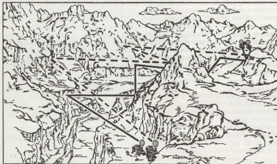
Für die Übermittlungsausrüstung wurden Deckungen geschaffen, die Fahrzeuge durch Tarnnetze abgedeckt, Schützenlöcher durch Gräben verbunden, die Zugänge zum Stützpunkt durch Minennester geschützt. Später kamen noch gedeckte Unterkünfte (Unterstände) hinzu. Alle diese Arbeiten mussten natürlich ausgeführt werden, ohne den Hauptauftrag, den Betrieb der Übermittlungsstation, zu vernachlässigen.
