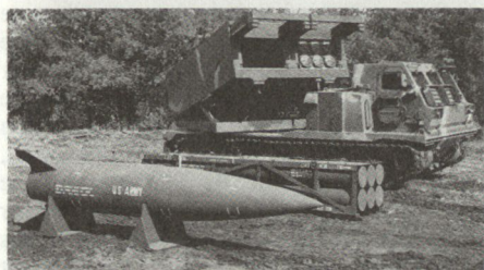
Taktische Lenkwaffe ATACMS, die ab Mehrfach-Raketenwerfer MLRS verschossen wird. Die Rakete ist mit einem modernen Trägheitsnavigationssystem ausgerüstet.
