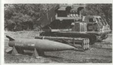
Taktische Lenkwaffe ATACMS, die ab Mehrfach-Raketenwerfer MLRS verschossen wird. Die Rakete ist mit einem modernen Trägheitsnavigationssystem ausgerüstet.
