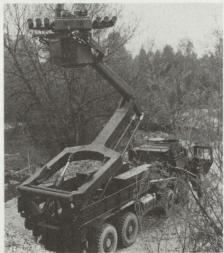
Das neu für die deutsche Bundeswehr geplante Pzaw-System PANTER mit total 6 PAL HOT auf einer elevierbaren Abschussplattform.
