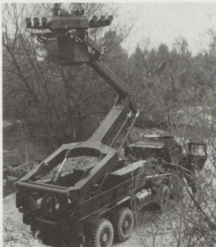
Das neu für die deutsche Bundeswehr geplante Pzaw-System PANTER mit total 6 PAL HOT auf einer elevierbaren Abschussplattform.
