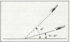
Abbildung 6: Anflugwinkel für ungelenkte Raketen
