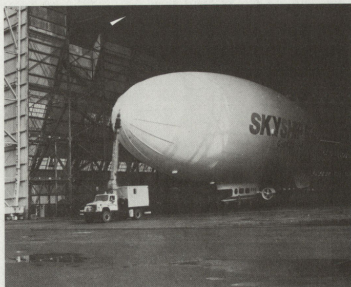
Abbildung 2. Prall-Luftschiff «Skyship 600», ein Vorläufermodell des «Sentinel 5000» (gut erkennbar einer der beiden Schwenk-Rotoren hinten an der Gondel).
