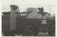
AC-Aufklärungsschützenpanzer BRDM-2/ RKh; die mit Druckluft ausgestossenen Markierfähnchen dienen zur Bezeichnung verseuchter Gebiete.
