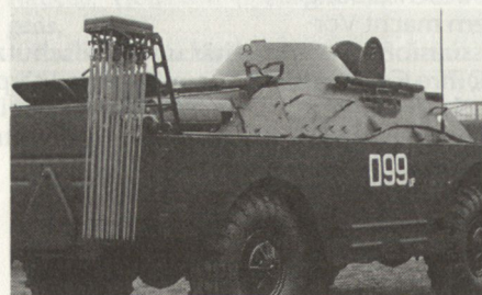
AC-Aufklärungsschützenpanzer BRDM-2/RKh; die mit Druckluft ausgestossenen Markierfähnchen dienen zur Bezeichnung verseuchter Gebiete.
