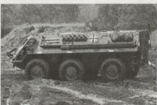
Basisversion Radschützenpanzers des FUCHS, schwimmfähig mit einer Transportkapazität für 14 Mann
