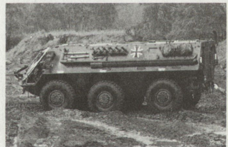
Basisversion des Radschützenpanzers FUCHS, schwimmfähig mit einer Transportkapazität für 14 Mann
