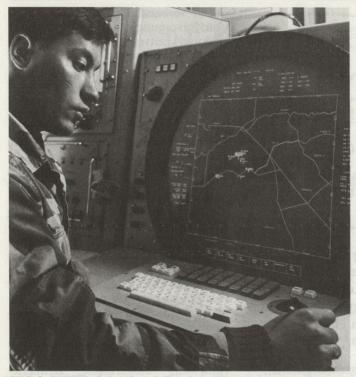
Bild 3. Datenempfangs- und -übertragungsgerät eines Artillerie-Schiesskommandanten.
