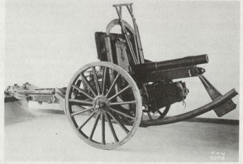
Bild 4. 7,5-cm-Feldkanone 1903 mit Bühlerschiene (1941)
